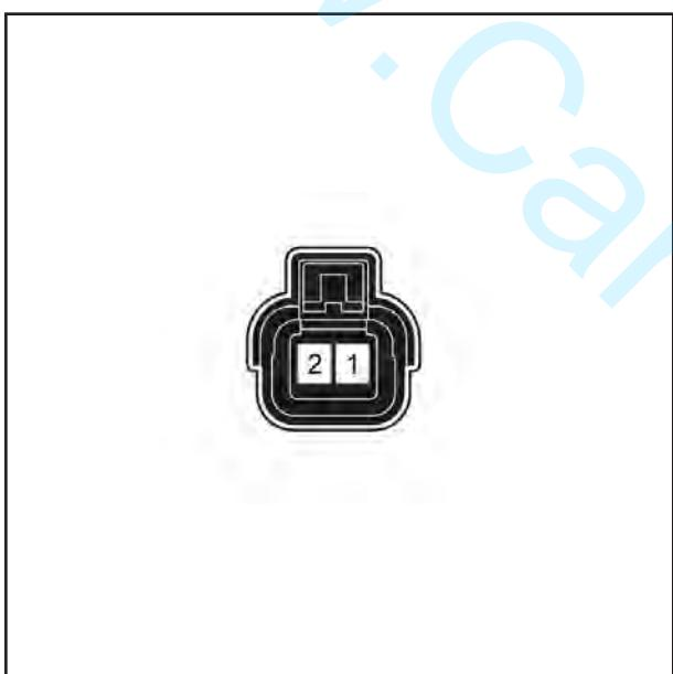
E13: کانکتور شیر خروجی تهویه کارتر روغن (OCV)
