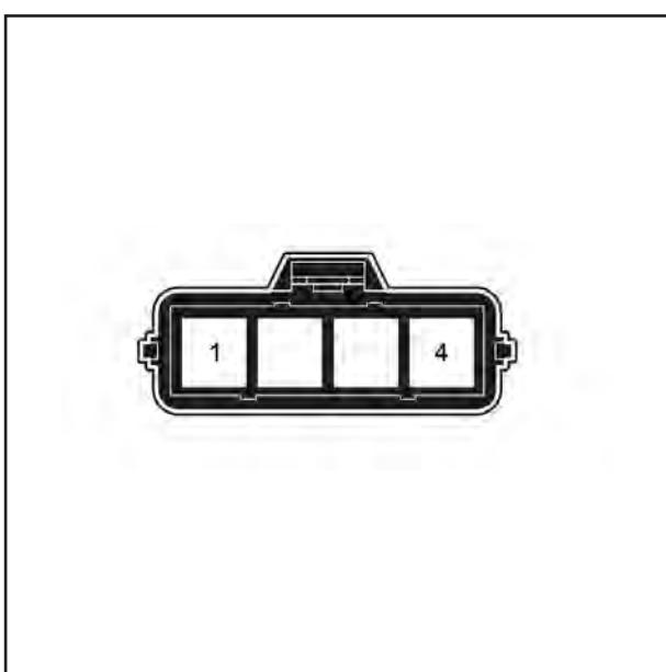
E10: کانکتور سنسور دما و فشار هوا و رودی
