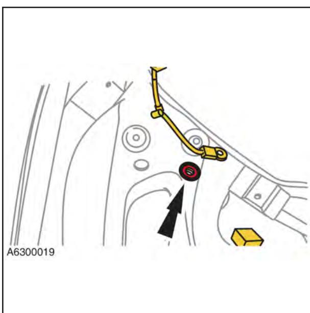
۳- سطح اتصال بست روی بدنه خودرو را با استفاده از سمباده
