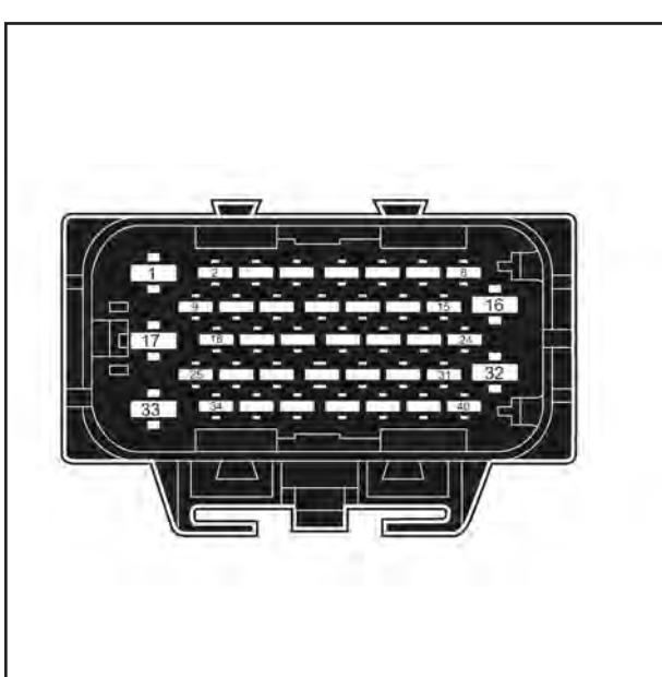
X03: اتصال دسته سیم موتور به کانکتور دسته سیم
