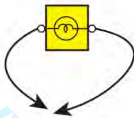
نحوه عملکرد ولت متر مشابه با لامپ تست می باشد با این تفاوت که ولت متر مقدار ولتاژ مدار را نیز نشان می دهد. برای بررسی ولتاژ از یک ولت متر با مقاومت بالا استفاده کنید. در صورت ضعیف بودن اتصال مدار، ممکن است ولت متر مقدار عادی را نشان دهد اما ولتاژ عملکرد مناسبی را ایجاد نمی کند.
